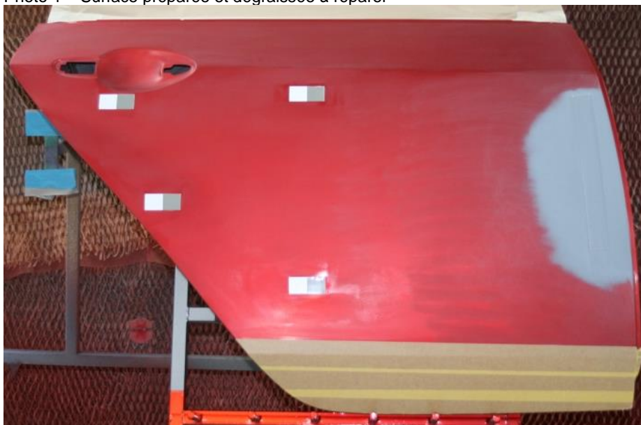
Photo 1 – Surface préparée et dégraissée à réparer
