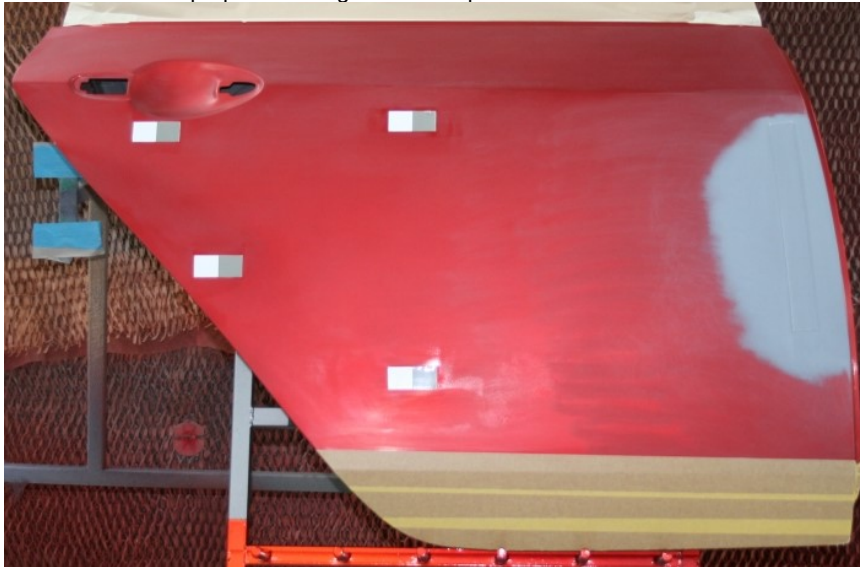
Photo 1 – Surface préparée et dégraissée à réparer
