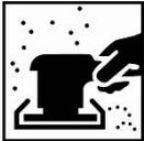
Alte Lackschichten und Polyesterlaminat: trocken schleifen mit P180-P280
