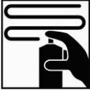
Sprühdose mit ca. 12-18 cm Abstand zum Objekt führen und 2 gleichmäßige Schichten auftragen. *Autosurfacer UV ist transparent um eine ordnungsgemäße Trocknung des Füllers zu ermöglichen. **Nicht auf Deckkraft lackieren. Eine zu hohe Schichtdicke kann Haftungsverluste aufgrund unzureichender Durchtrocknung verursachen.***
