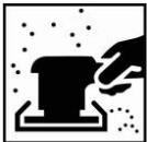
Entfernen bestehender Lackschichten und als letzten Schleifschritt mit P180 - 220 trocken bis auf den blanken Untergrund schleifen.
