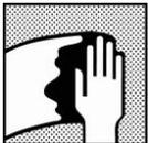
Entfernen Sie vor dem Spachtelauftrag jegliche Oberflächenverunreinigung unter Verwendung entsprechender Oberflächenreiniger.
