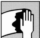
Entfernen Sie vor dem Auftragen von Grundierung / Füller jegliche Oberflächenverunreinigung unter Verwendung entsprechender Oberflächenreiniger.
