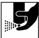
Nach Gebrauch Sprühdose wenden und Düse 2-3 Sekunden freisprühen. Dies ermöglicht dem Treibgas die Düse ausreichend für den weiteren Gebrauch zu reinigen.
