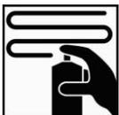
Sprühdose ca. 12-18 cm entfernt vom Teil halten und 2-3 gleichmäßige Schichten auftragen. Empfohlene Verarbeitungstemperatur zwischen 15°C-35°C.
