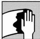
Mit einer Überlappung von 50- 75% manuell über die Oberfläche wischen.
