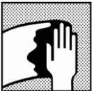
Vollständiges Entfernen von Oberflächenverunreinigungen unter Verwendung von geeigneten Oberflächenreinigern.
