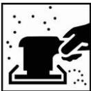
Schleifen; Endschliff trocken mit P320
