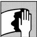
Entfernen Sie vor dem Auftragen von Sealer Plus jegliche Oberflächenverunreinigung unter Verwendung entsprechender Oberflächenreiniger.
