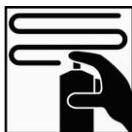
Maintenir l'aérosol à environ 12-18 cm (5"-7") du panneau et appliquer 2-3 couches homogènes.
