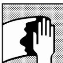
Remova contaminação usando um desengraxante de superfície apropriado.
