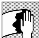
Remova a contaminação da superfície usando um desengraxante de superfície apropriado.
