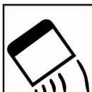
Aplique o bodybuilder de poliéster no substrato sem revestimento, colocando a espátula em um ângulo de 60°. Evite bordas grossas da massa em torno do perímetro do reparo, afinando em direção ao acabamento original.
