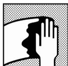
Remova a contaminação da superfície usando um desengraxante de superfície apropriado. Limpar previamente a superfície com água morna e detergente, enxaguar abundantemente com água limpa.
