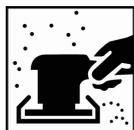
Remova o revestimento existente e lixe até o substrato nu usando o grão P180 - P220 como a etapa final. Para uma preparação detalhada da superfície ver TDS S8.06.02
