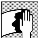
Очистка поверхности перед нанесением: удаление всех загрязнений подходящим обезжиривателем.
