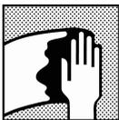
Limpieza de la superficie; eliminar cualquier contaminación antes de lijar utilizando un limpiador de superficies adecuado.
