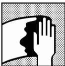
Limpieza de la superficie; eliminar cualquier contaminación antes de aplicar Autosurfacer UV utilizando un limpiador de superficies adecuado. Evitar el contacto entre masilla de polyester y el agua, incluyendo desengrasante base agua.
