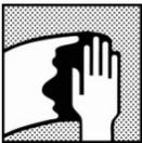
Nettoyer la surface avant d'appliquer Polysurfacер avec un nettoyant approprié.
