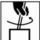
Polysurfacер doit être mélangé soigneusement avant utilisation.
