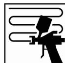
2 geschlossene Spritzgänge auftragen mit einer Zwischenablüßzeit von 0-3 Minuten bei 20 °C
