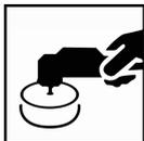
Staub und geringfügige Fehlstellen können nach 15 Minuten nach den angegebenen Trocknungszeiten auspoliert werden.
