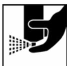
Después de la aplicación, invertir el aerosol y presionar la boquilla durante 2-3 segundos. Esto permite limpiar la boquilla para su posterior uso.
