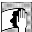
Prelavar la superficie con agua tibia y detergente y aclarar suficientemente con agua limpia. Retirar la contaminación de la superficie con M700, Anti Static Degreaser o M850.
