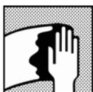
Limpieza de la superficie; retirar la contaminación utilizando M700, Anti Static Degreaser o M850.
