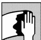
Pulire la superficie, rimuovendo ogni traccia di contaminante prima della carteggiatura, utilizzando un detergente appropriato.
