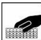
Abradere l'area "b" (chiusura del pannello) utilizzando Blend Prep in combinazione con acqua ed un tampone abrasivo idoneo.
