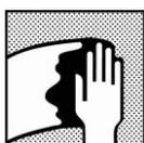
Pulire la superficie, rimuovendo ogni traccia di contaminante prima dell'applicazione della finitura, utilizzando un detergente appropriato.
