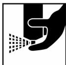
Depois da aplicação, inverter o aerosol e manter apertada a boca entre 2-3 segundos.
