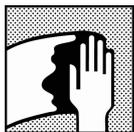
Limpeza das superfícies, eliminar qualquer contaminação da superfície antes de lixar utilizando o limpador/desengordurante adequado.
