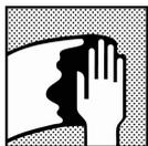
Limpeza de superfícies: eliminar qualquer contaminação da superfície antes de lixar utilizando o limpador/desengordurante adequado.
