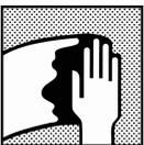
Eliminar qualquer contaminação da superfície antes de aplicar aparelho utilizando o limpador/desengordurante adequado.
