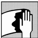
Eliminar qualquer contaminação antes de aplicar aparelho mediante um limpador de superfícies adequado. Evitar todo contacto com a água, por exemplo desengordurantes base água.
