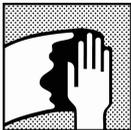
Limpeza da superfície; eliminar qualquer contaminação antes de lixar utilizando um limpador de superfícies adequado.
