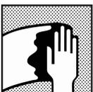
Limpeza da superfície; eliminar toda contaminação antes de aplicar qualquer produto utilizando um limpador de superfícies adequado.
