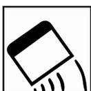
Нанесите полиэфирную шпатлевку на зачищенные до металла поверхности, держа шпатель под углом 60°. Сглаживайте кромки.
