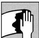
Очистка поверхности перед нанесением грунта-выравнивателя: удаление всех загрязнений подходящим обезжиривателем.
