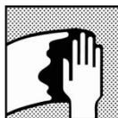
Очистка поверхности перед нанесением базового покрытия: удаление всех загрязнений, рекомендованным способом обезжиривания, используя рекомендованную последовательность применения обезжиривателей; сначала M600 или M700, затем M200.
