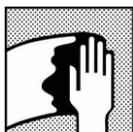
Pulire la superficie, rimuovendo ogni traccia di contaminante prima della carteggiatura, utilizzando un detergente appropriato.
