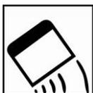
Applicare lo stucco utilizzando una spatola, mantenuta ad un'inclinazione di 60° rispetto alla superficie. Livellare i bordi dello stucco applicato.
