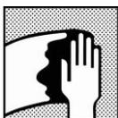
Pulire la superficie, rimuovendo ogni traccia di contaminante prima dell'applicazione del prodotto, utilizzando un detergente appropriato.
