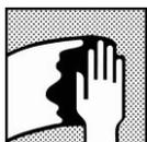
Pulire la superficie, rimuovendo ogni traccia di contaminante prima dell'applicazione del prodotto, utilizzando un detergente appropriato.
