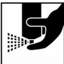
Dopo l'uso, capovolgere la bomboletta e spruzzare per 2-3 secondi per pulire l'ugello. Questo permetterà al propellente di pulire l'ugello in modo soddisfacente per gli utilizzi successivi.
