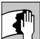
Eliminar los restos de lijado utilizando un limpiador de superficies adecuado.
