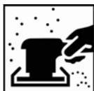
Eliminar la pintura existente y lijar hasta llegar a metal descubierto utilizando P180 - P220 como fase final. *Para información detallada sobre preparación de superficies consultar TDS S8.06.02*
