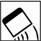
Aplicar la masilla de polyester sobre el metal descubierto colocando la espátula en un ángulo de 60°. Evitar la formación de contornos gruesos de masilla retirando el exceso a nivel del acabado original.
