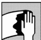
Limpiar la zona a reparar con agua tibia y jabonosa y aclarar con agua completamente con agua limpia. Eliminar la contaminación de la superficie utilizando un limpiador adecuado.
