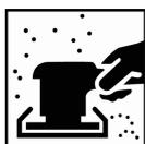
Lijado; lijado final en seco; P220 - P320
