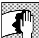
Limpieza de la superficie; eliminar cualquier contaminación de la superficie antes de la aplicación de Colorbuild Plus utilizando un limpiador apropiado. Donde haya expuesta masilla, evitar el contacto con agua (ej. desengrasante base agua).
