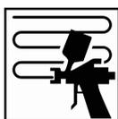
**Lijable;** Aplicar una capa sobre toda la superficie lijada. Después aplicar la 2ª y la 3ª capa dentro de la capa anterior. Cuando se requiera aplicaciones de alto espesor aplicar 2-3 capas sobre el panel completo dependiendo del espesor necesario.
