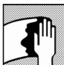
Limpieza de la superficie, eliminar cualquier contaminación de la superficie antes de lijar utilizando el limpiador/desengrasante adecuado.
