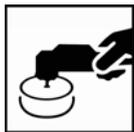
Es posible pulir motas y pequeñas imperfecciones una vez que los tiempos de secado por aire establecidos se hayan cumplido; o después de un secado completo a una temperatura del objeto de 60°C, seguido por enfriamiento hasta alcanzar una temperatura ambiente. Lijar cuidadosamente para eliminar todas las partículas de polvo y repare la superficie de acuerdo con las recomendaciones para el pulido.
