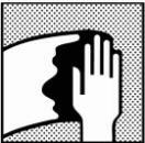
Oberfläche mit warmem Wasser und Seifenlauge gründlich vorreinigen, ggf. eine feste Bürste verwenden, um Rückstände von Trennmittel zu entfernen. Ausreichend mit klarem Wasser abwaschen.
