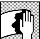
Oberflächenreinigung; Jegliche Oberflächenverunreinigungen mit M700, Antistatic Degreaser oder M200 entfernen.
