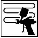
Eine volle Schicht über die komplett geschliffene Oberfläche auftragen. Anschließend eine zweite und dritte Schicht innerhalb der vorherigen Schicht auftragen. Bei einer Lackierung des ganzen Teils, 2-3 Schichten über das gesamte Teil auftragen, abhängig von der gewünschten Schichtdicke.
