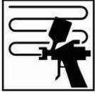
Einen mittleren geschlossenen Spritzgang auftragen, gefolgt von einer Ablüfzeit von 5-10 Minuten bei 20°C.
