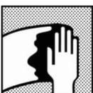
表面清洁, 喷涂油性底色漆前, 使用正确的除油剂及除油步骤来去除工件表面的所有污染物
