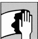
喷涂面漆之前，先利用新劲 M700 或 M600 除油剂，去除板件上的污染物。
