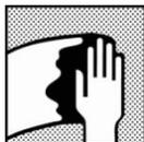
任何打磨前,先利用正确的除油剂,去除板件上的污染物。
