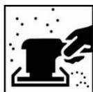
最后打磨羽状边(板件周边打磨)的砂纸粗细度要求 P320 - P400
