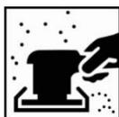
去除旧漆膜,及后利用 P120-P220 干磨砂纸对底材周边范围进行羽状边打磨
