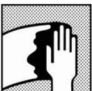
完成聚酯原子灰打磨后, 请使用正确的除油剂, 对施工表面先进行彻底除油清洁处理
