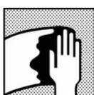
刮涂聚酯原子灰之前,请使用正确的除油剂,对施工表面先进行除油清洁处理
