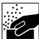
原子灰干固后,可先使用 P80 - P120 打磨
