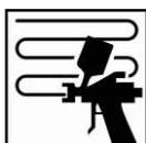
Нанесение двух одинарных слоев, с выдержкой между слоями 3-5 минут при 20°C
