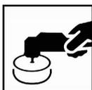
A poeira e as imperfeições menores podem ser polidas após o tempo de secagem ao ar indicado, ou após cura completa a 60°C, seguida por resfriamento para a temperatura ambiente.
