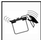
Bien agiter Autowave MM 2.0 avant utilisation pour une viscosité optimale des teintes MM avant de mélanger la couleur. Les teintes métallisées Autowave MM 800 doivent être soigneusement mélangées lors de la première utilisation, puis agitées comme pour toutes les teintes de base MM.
