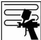
Appliquer une couche moyenne en respectant un temps d'évaporation de 1-3 minutes à 20°C. Ensuite, appliquer une couche pleine, en respectant un temps d'évaporation de 5-7 minutes à 20°C avant étuvage.
