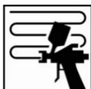
Appliquer 2 couches et laisser évaporer jusqu'à l'obtention d'un aspect mat entre les couches et avant étuvage.
