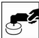
La poussière et les dégâts mineurs peuvent être polis après étuvage et séchage complet suivant les indications données ci-dessus, suivi d'un refroidissement de l'élément à température ambiante. Poncer soigneusement les particules de poussière et restaurer la surface selon les recommandations de ponçage .
