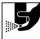
Après l'application, nettoyer la buse en tenant l'aérosol tête en bas et en pulvérisant 2-3 secondes. Cela permet un nettoyage de la buse par l'agent propulseur suffisant pour une utilisation ultérieure
