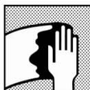
Nettoyage de la surface avant ponçage avec un nettoyant approprié.
