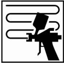
Zwei verlaufende Einzelschichten auftragen und eine Zwischenablüßzeit von 2-3 Minuten bei 20°C gewähren. Endablüßzeit von 2-3 Minuten bei 20 °C vor dem Bestrahlen mit UV-Licht gewähren.
