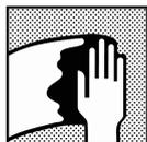
Eliminar totalmente la contaminación de la superficie antes del proceso de lijado con un limpiador de superficies adecuado.
