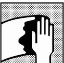
Eliminar toda contaminación existente antes de la aplicación de cualquier imprimación o aparejo utilizando un limpiador de superficies adecuado.
