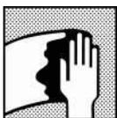
Nettoyer la surface; essuyer toutes traces de poussières en utilisant le M700 (Anti Static Degreaser) ou M850. Eviter les contacts avec l'eau aux endroits où est exposé le mastic (ex : dégraissants à l'eau).
