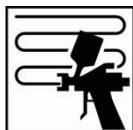
Appliquer deux couches fermées qui coulent, permettant un temps d'évaporation de 2 à 3 minutes à 20 ° C. Ensuite, laisser agir pendant 2 à 3 minutes à 20 ° C avant l'exposition à la lumière UV.
