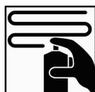
Manter o aerosol aproximadamente a 12-18 cm do painel e aplicar 1-2 demãos finas. Temperatura recomendada de aplicação entre 15°C-35°C. Nível de humidade relativa máxima durante a aplicação: 75 %.
