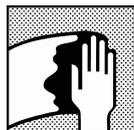
Eliminar qualquer contaminação da superfície antes de lixar utilizando o limpador/desengordurante adequado. *Pré-lavar a superfície com água tibia e sabão. De seguida, aclarar bem com água limpa.*
