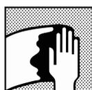
Limpeza da superfície, eliminar qualquer contaminação da superfície antes da aplicação de Washprimer 1K CF utilizando o limpador/desengordurante adequado. *Se existir betume a descoberto, evitar que entre em contacto com a água (por ex.: desengordurante base água).*
