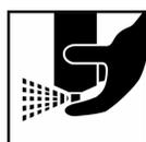
Depois da aplicação, inverter o aerosol e manter apertada a boca entre 2-3 segundos. Isto permite que a boca fique bem limpa para a sua próxima utilização.
