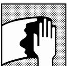
Limpeza de superfícies: eliminar qualquer contaminação da superfície antes de aplicar Primer Surfacer EP II utilizando o limpador/desengordurante adequado. *Se existir betume a descoberto, evitar que entre em contacto com a água (por ex.: desengordurante base água).*
