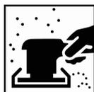
Lixagem; acabamentos existente lixagem final; P220 - P320
