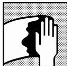
Limpeza da superfície, eliminar qualquer contaminação da superfície antes de lixar utilizando o limpador/desengordurante adequado.
