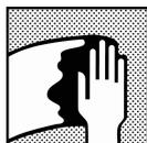
Limpeza de superfícies: eliminar qualquer contaminação da superfície antes de aplicar Primer Surfacer EP II utilizando o limpador/desengordurante adequado.
