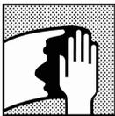
Eliminar qualquer contaminação da superfície antes de aplicar o betume utilizando o limpador/desengordurante adequado.
