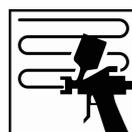
Aplicar uma camada sobre toda a superfície lixada. De seguida, aplicar a segunda e terceira camada dentro da área de cada uma das camadas precedentes. Sempre que se necessite de uma aplicação completa em todo o painel, aplicar 2 ou 3 camadas em todo o painel em função da espessura pretendida.
